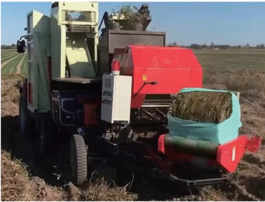
图 13 包膜装置田间试验
