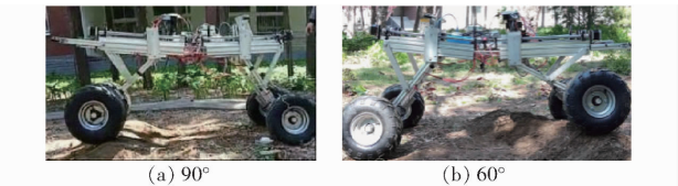
图 13 地面调平试验 Fig. 13 Leveling tests on ground
