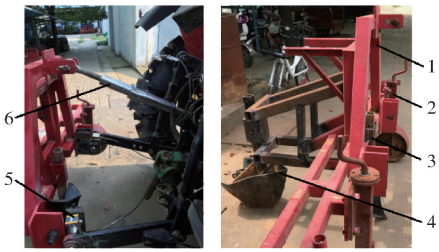
图 5 开畦沟装置田间测试装置
