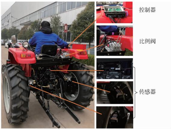
图8 实验拖拉机实物图
