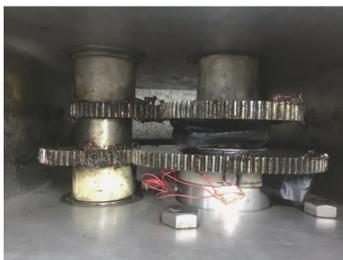
图 10 无线传感器和应变片的安装位置
