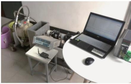
图 8 差速泵转矩特性试验台
