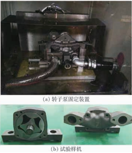
图 10 测试装置及样机 Fig. 10 Testing device and prototype
