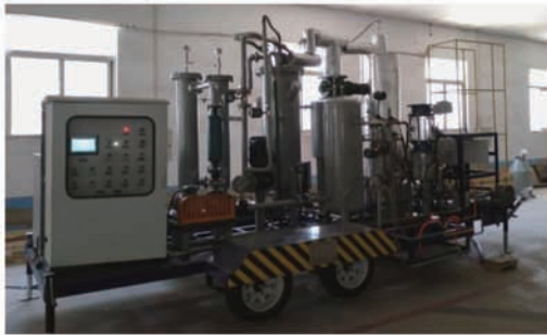
图 6 移动式生物质快速热裂解装置
