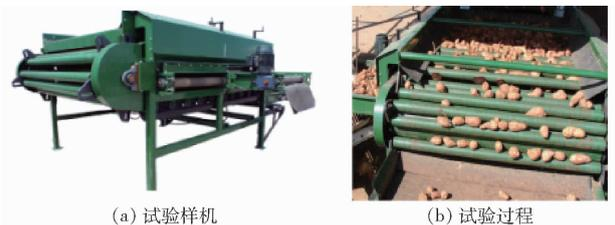
图10 辊式马铃薯分级机试验
