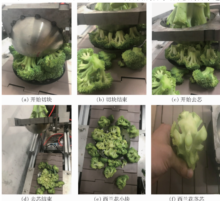
图 12 西兰花切块去芯机构各关键位置姿态与切块效果
