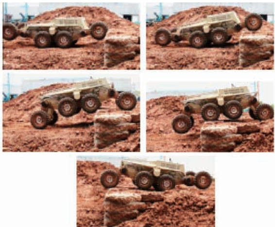
图 14 无人平台样机越障过程
