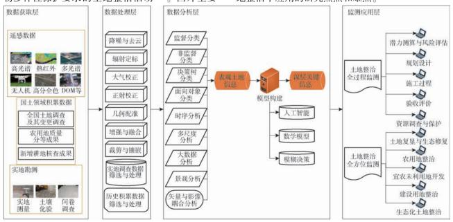
图 1 土地整治遥感监测体系架构图
