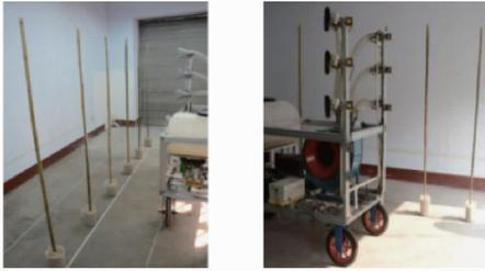
(a) 测距传感器返回值的测量 (b) 50 cm水平距离时的测量
