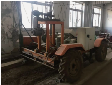
图 10 土槽验证试验 Fig. 10 Soil tank verification test
