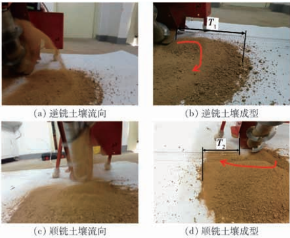
图 5 铣削试验效果 Fig. 5 Test effects of milling principle
