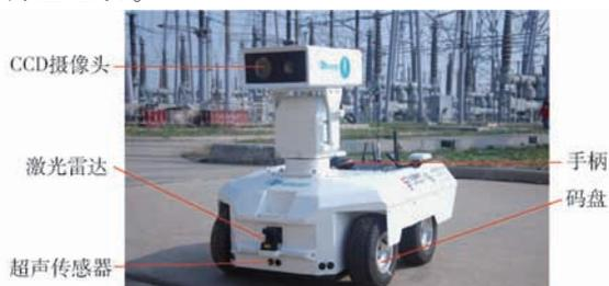
图5 机器人实验平台
