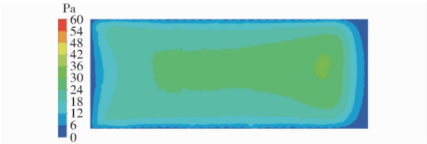
图 7 振动槽上的压力分布云图
