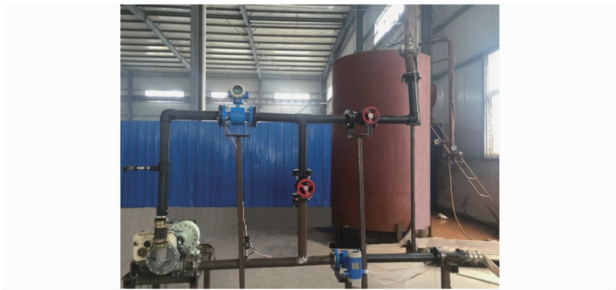
图 6 水涡轮性能测试试验台
