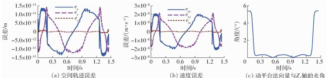
图 10 末端执行器的运动状态
