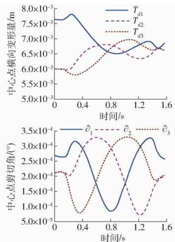
图 8 柔性杆中心点的横向变形和剪切角
