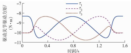
图 5 正动力学模型的输入驱动力矩
