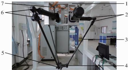
图 3 3-RRRU 刚柔耦合并联机器人
