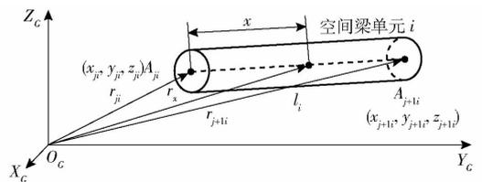
图1 NCF法描述的空间刚性梁单元模型
