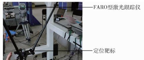
图13 激光跟踪仪测量系统
