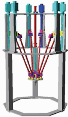
图 5 机构 6PUS + UPU 动力学仿真模型
