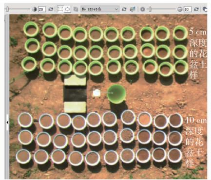
图 3 土样 R、G、B 波段合成的真彩色影像
