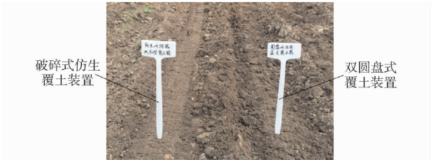
图 13 破碎式仿生覆土装置与双圆盘式覆土装置对比试验(加装镇压轮)
