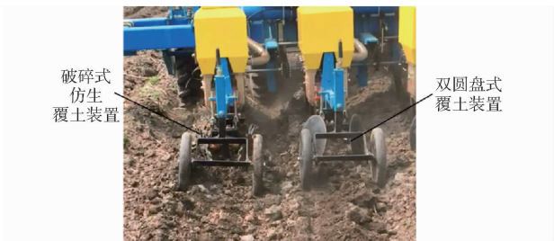
图 12 破碎式仿生覆土装置与双圆盘式覆土装置对比试验(不加装镇压轮)
