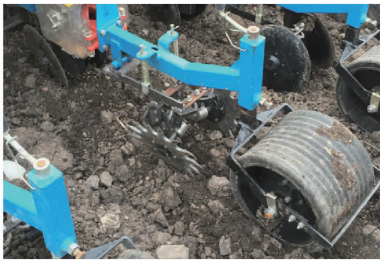
图 11 破碎式仿生覆土装置覆土性能试验
