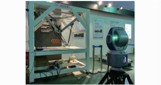
图 16 机器人工作空间扫描试验现场
