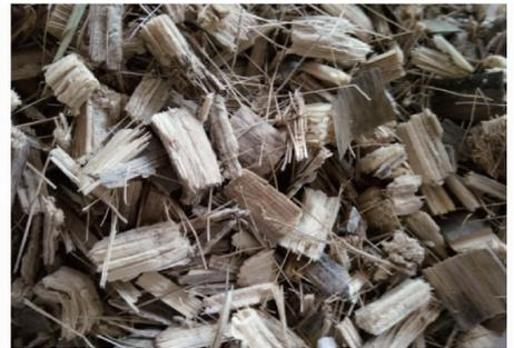
图13 秸秆碾压揭皮切段后皮瓢分离形态
