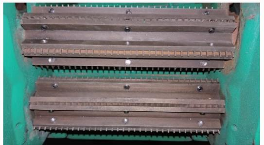
图9 碾压揭皮辊装配图
