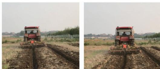
(a) 限深深度 130 mm 时作业效果 (b) 限深深度 180 mm 时作业效果
