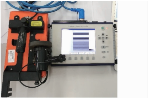
图 2 探地雷达 Fig. 2 Ground penetrating radar
