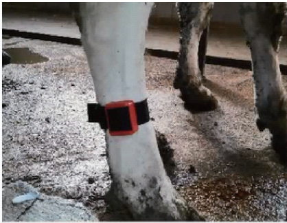
图 1 佩戴在奶牛右后肢上的计步器 Fig. 1 Pedometer on cow limb
