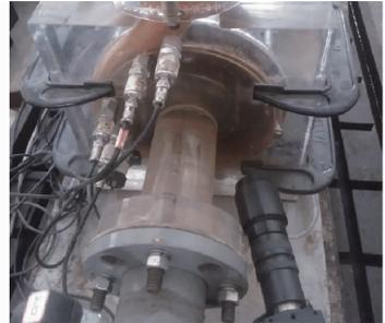
图1 试验泵及可视化拍摄角度
