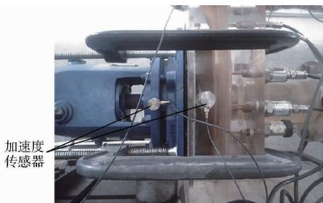
图 3 加速度传感器安装位置
