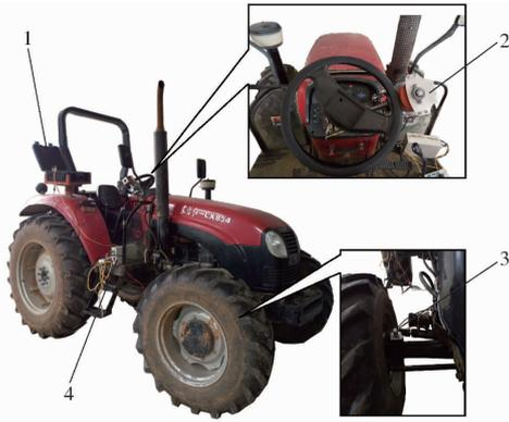
图9 转向驱动系统试验平台
