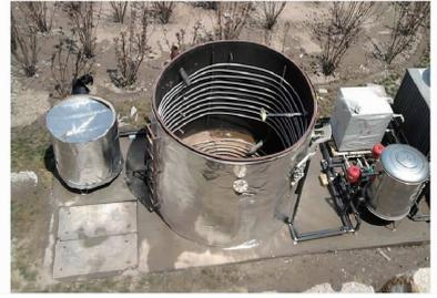
图 6 基于太阳能热泵加温的厌氧发酵试验台
