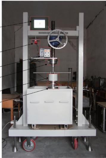
图5 地面力学参数综合测试系统实物图
