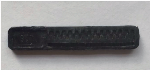
图 2 迷宫流道灌水器及有机玻璃试验样件 Fig. 2 Schematics of labyrinth channel emitter and specimen
