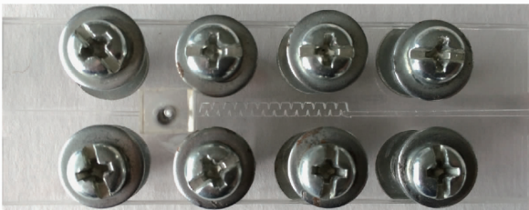
图 2 迷宫流道灌水器及有机玻璃试验样件 Fig. 2 Schematics of labyrinth channel emitter and specimen
