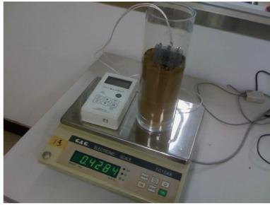
图9 渗水称量法土壤测试试验装置
