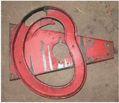
图 3 优化前凸轮轨道 Fig.3 Original cam
