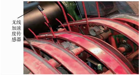
图 6 无线加速度传感器布置 Fig.6 Wireless acceleration sensor arrangement
