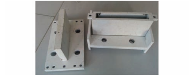
图 4 预压缩装置实物 Fig. 4 Mock-ups of pre-compression device
