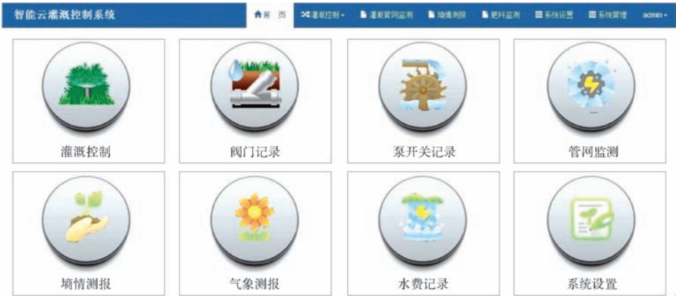
图4 智能云灌溉控制系统软件界面
