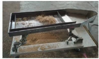
图 13 3T-1R 并联振动筛样机
