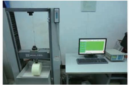
图 4 车轮轮面承压沉陷试验过程
