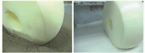
图 8 凸面 R80 车轮下陷状态图
