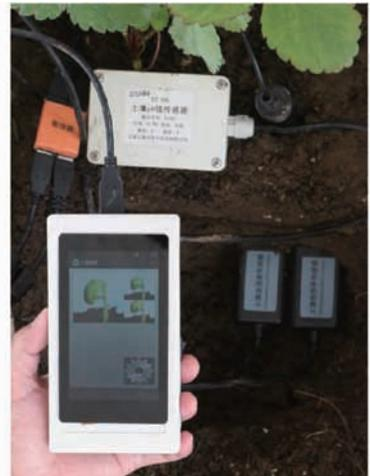
图 8 检测终端应用(土壤多参数检测)
