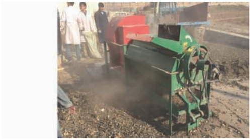
图8 花生摘果装置摘果试验
