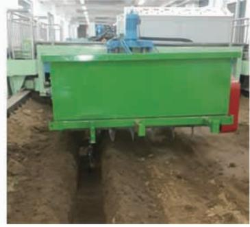
图9 正弦指数曲线型开沟刀片土槽验证试验
