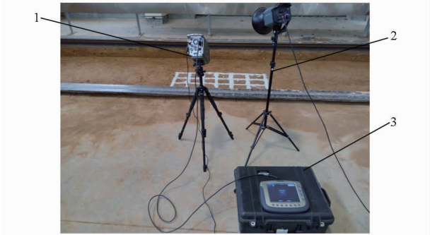
图 3 高速摄影机机位布置图 Fig. 3 Position of high-speed camera 1. 高速摄影机 2. 补光设备 3. 控制器
