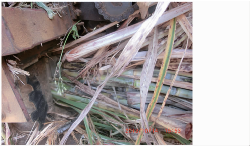
图 3 切割器堵塞图 Fig.3 Cutter jam real photo
