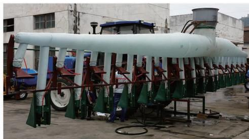
图2 棉花分行冠内冠上组合风送式喷杆喷雾机样机
