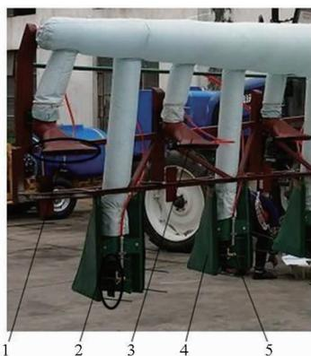
图 4 导风筒结构
