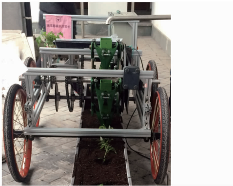
图 7 栽植器试验台土槽验证试验
