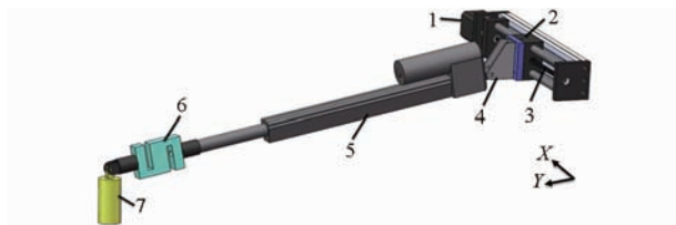
图 3 拖拉机驾驶机器人换挡机械手三维模型
