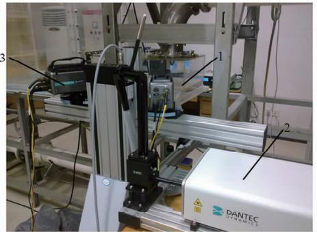
图 8 2D3C-PIV 激光测试试验系统
