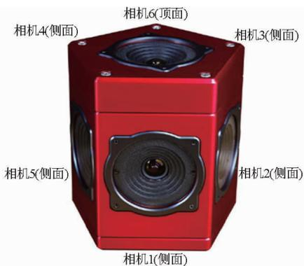
图1 Ladybug3 多目全景视觉系统结构
