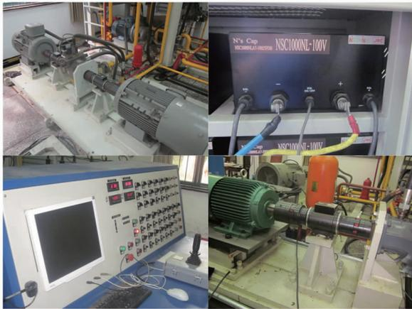
图 6 基于液压加载的永磁发电机试验台架实物图
