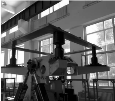
图 4 标定块惯性参数测量试验
