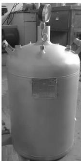
图 6 直接换热式热水加热器
